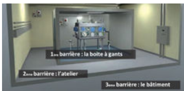
▲ Les 3 barrières de confinement de l'usine Melox
