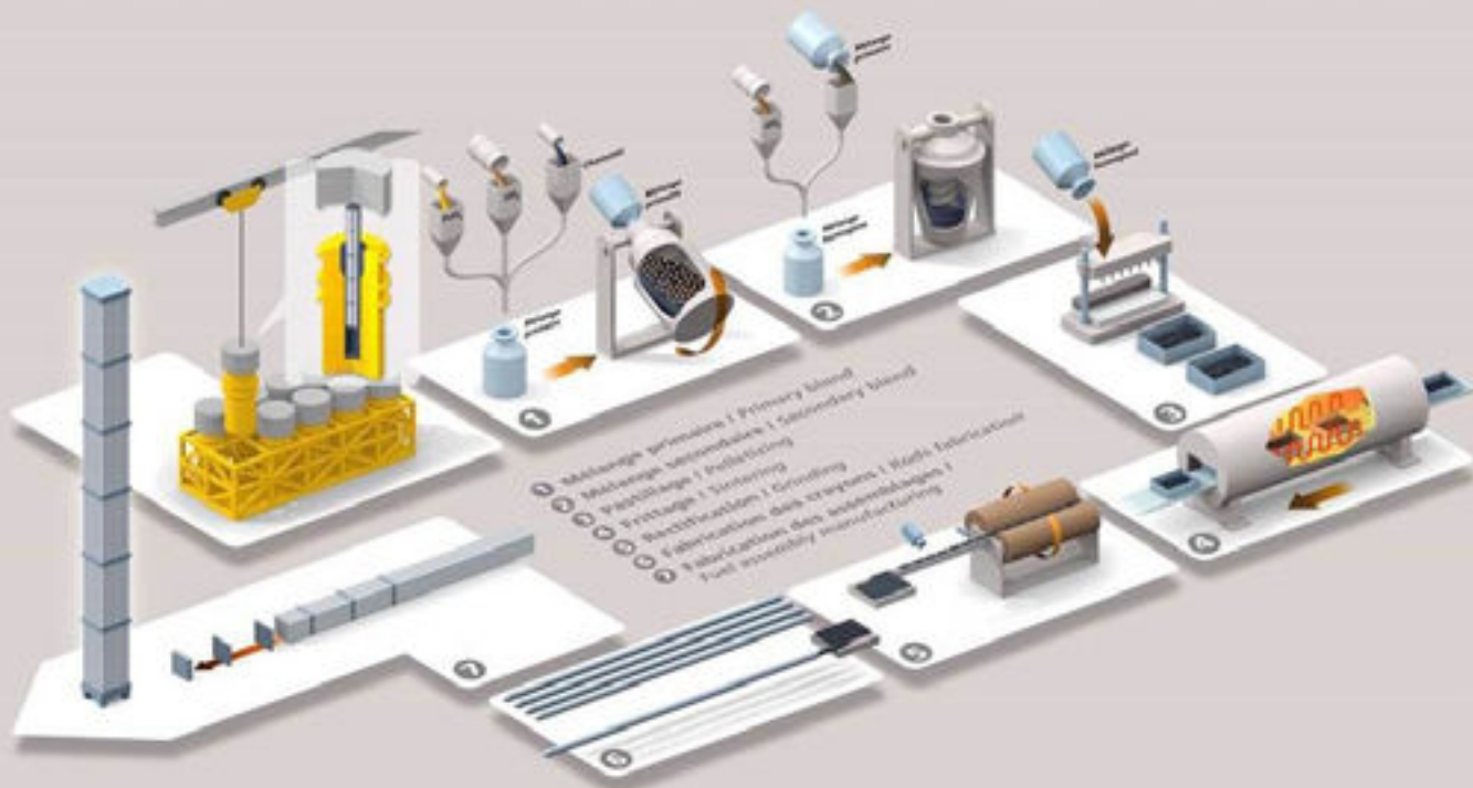
Procédé de fabrication du combustible MOX à Melox
